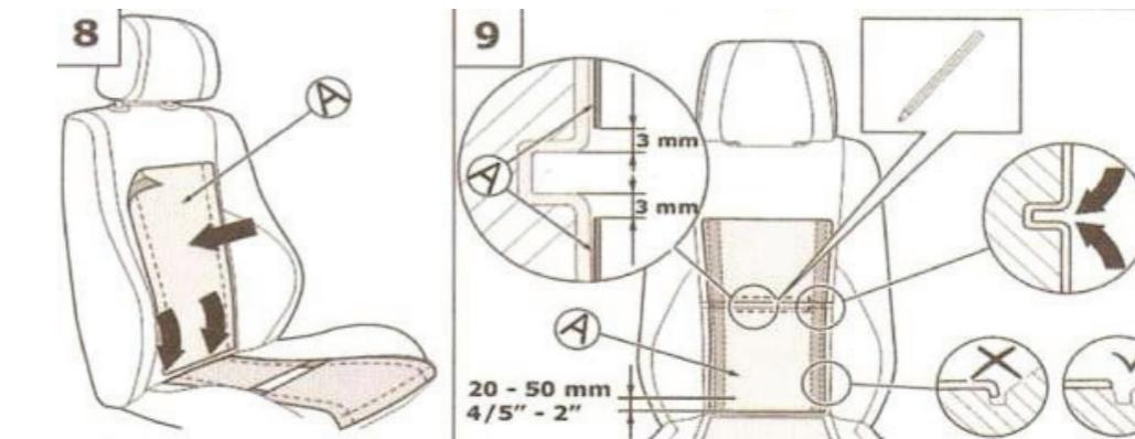
Podľa naznačeného miesta urobte otvor do vyhrievacieho telesa. Na operadlovej časti urobte vyzenaním priestor na termostat vyhrievacieho telesa, aby potom nevyčnieval a neprekážal obsluhe pri sedení. Dĺžku vyhrievacích telies prispôsobte podľa obrázka.
