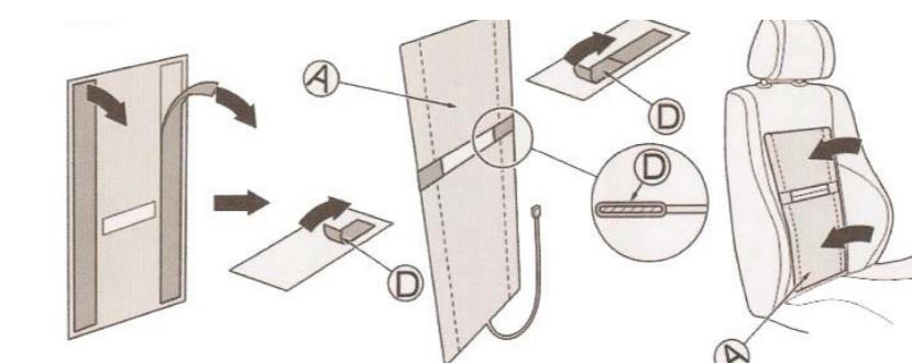
Čalúnenie sedadla dajte na pôvodné miesto a sedadlo poskladajte do pôvodného stavu. Vodiče z jednotlivých častí vyhrievania spojte pod sedadlom a upevnite ich tak, aby nebránili pri pohybe sedadla alebo aby nedošlo k ich poškodeniu. Napájacie vodiče vyhrievania zapojte podľa schémy zapojenia a druhú stranu vodičov dotiahnite pod sedadlo, do ktorého ste namontovali vyhrievanie. Vodiče umiestnite tak, aby nedošlo k ich poškodeniu.
