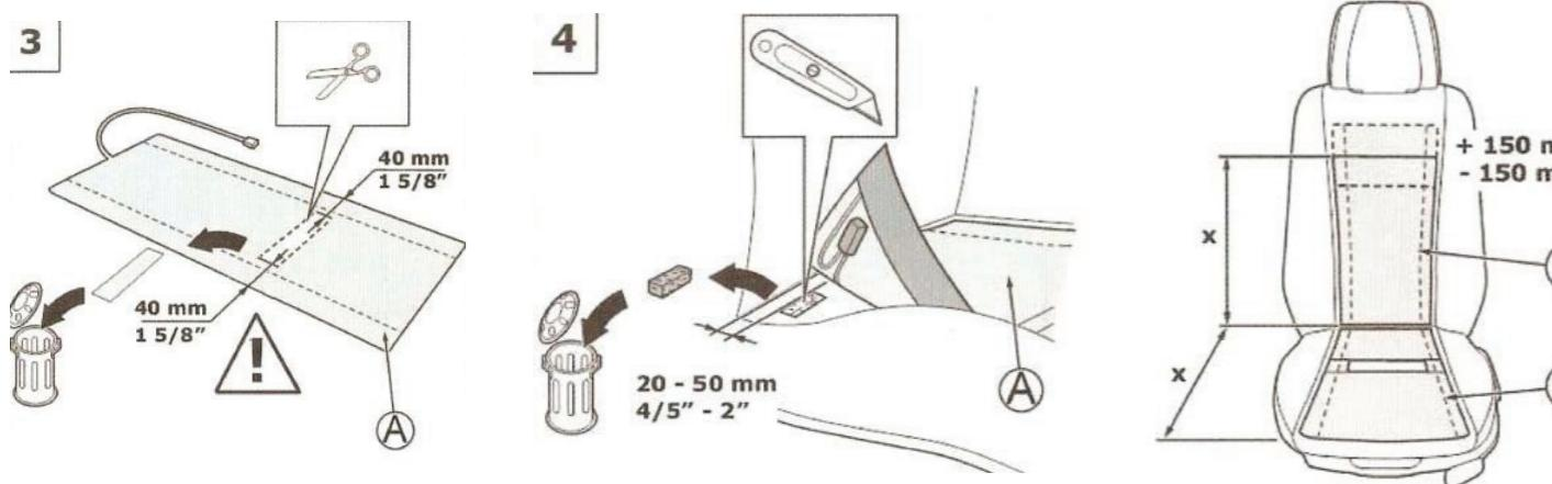
Podľa naznačeného miesta urobte otvor do vyhrievacieho telesa. Na sedadle urobte vyzenaním priestor na termostat vyhrievacieho telesa, aby potom nevyčnieval a neprekážal obsluhe pri sedení. Dĺžku vyhrievacích telies prispôsobte podľa obrázka.
